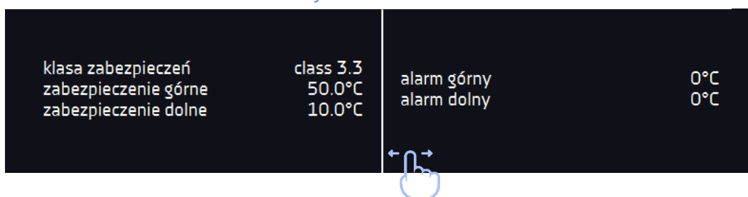
Snímek 9 - Status – ochrana a alarmy
